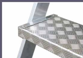
Gradino profondo 200mm realizzato in lamiera mandorlata che garantisce gradini molto robusti con spessore 3mm ed un anti-scivolo alto 2mm particolarmente efficace
